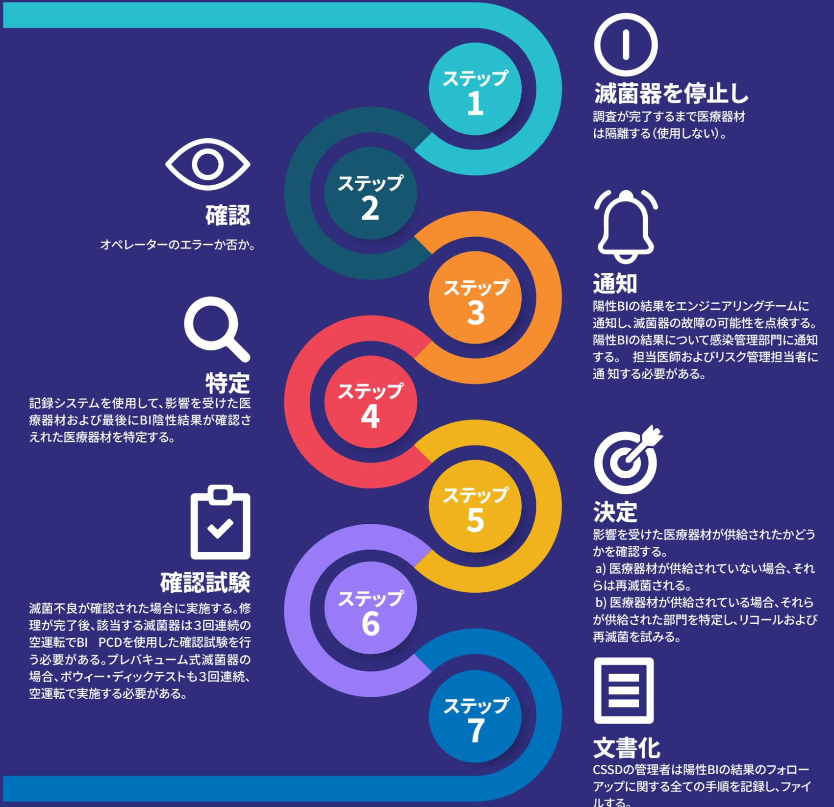
滅菌器は、生物学的インジケータ (BI) を使用して、すべての滅菌パラメータが達成されていることを実証するためにテストされる。陽性の生物学的インジケータが発生した場合、対応策が実施される。滅菌不良の原因がすぐに特定できない場合、医療器材を隔離し、最後の陰性結果のBIが出た滅菌回まですべての医療器材をリコール(回収) する必要がある。
